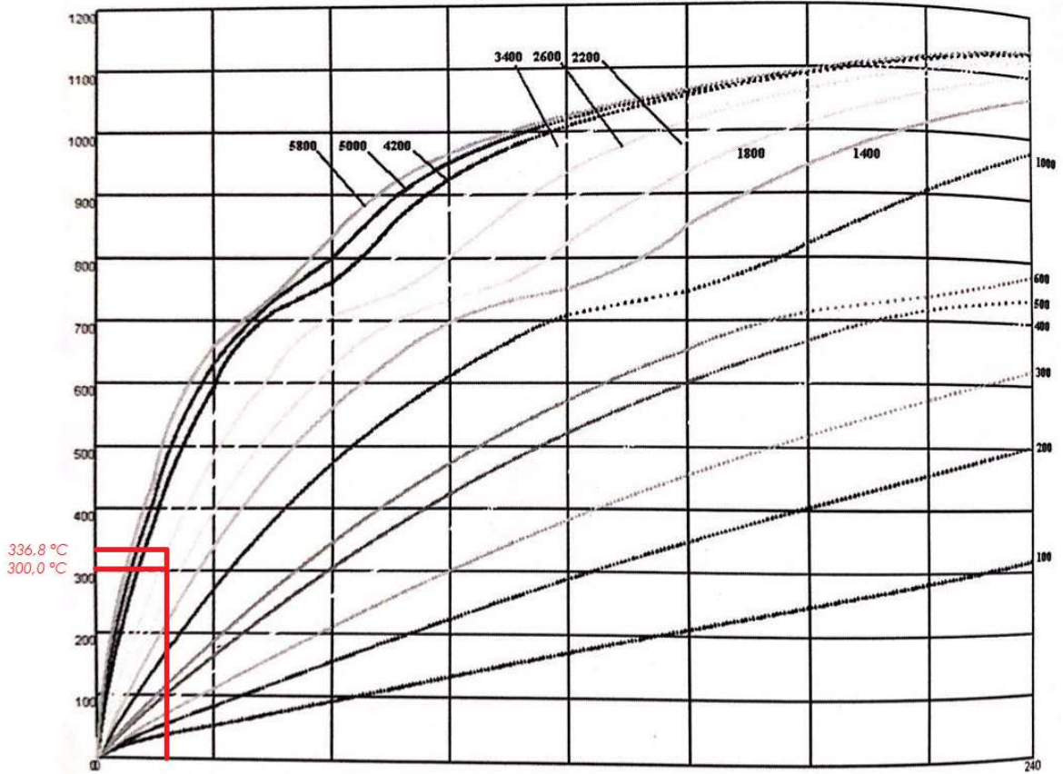
Imagen 21. Gráfica para el cálculo de la temperatura del acero según la conductancia de la protección y el tiempo de exposición (Curva T-t paramétrica).
