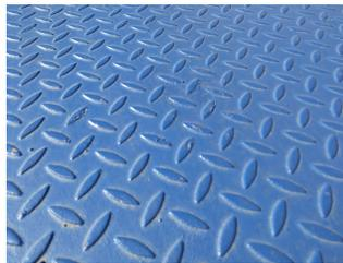
Figura 1.5: Chapa labrada de los tableros
