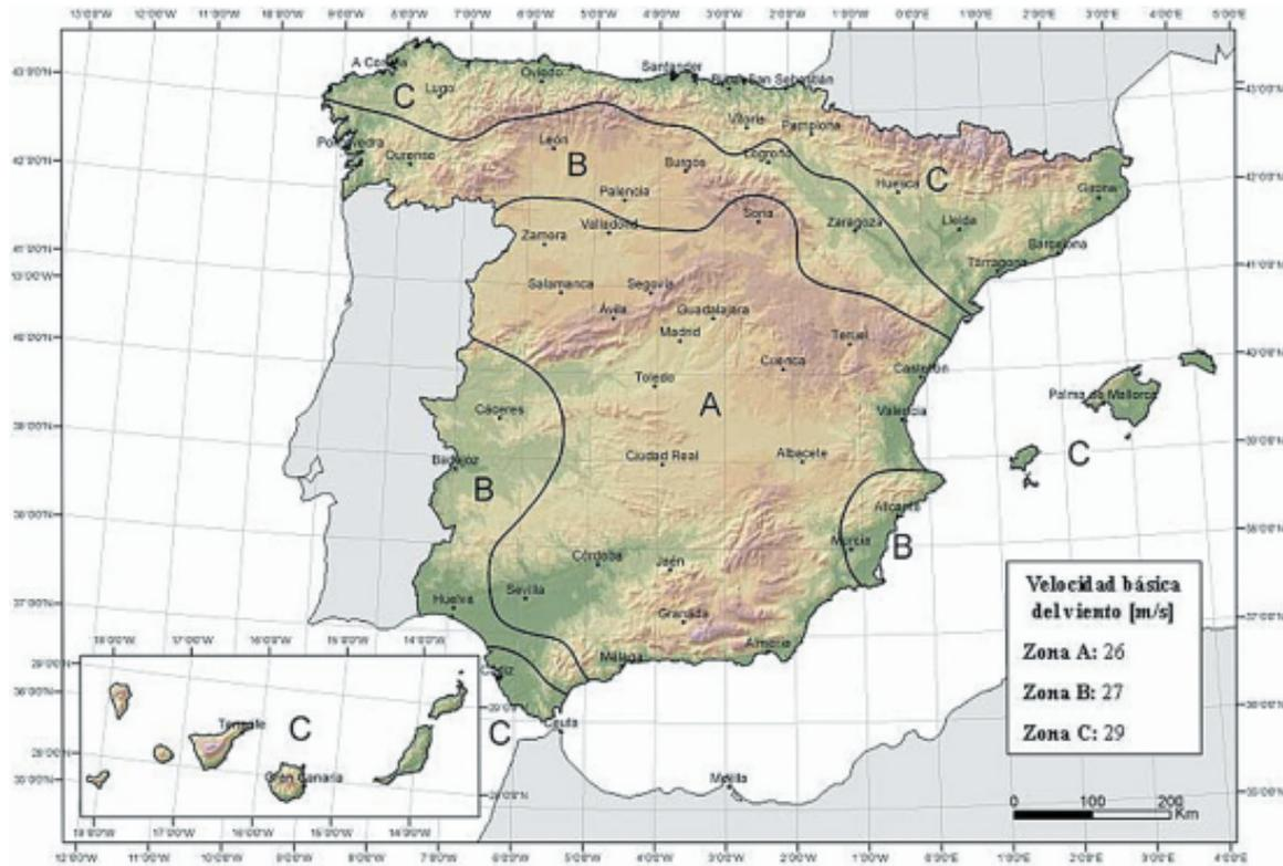
Figura B.1: Mapa de isotacas para la obtención de la velocidad básica fundamental del viento  $v_{b,0}$  (fuente: IAP-11)
