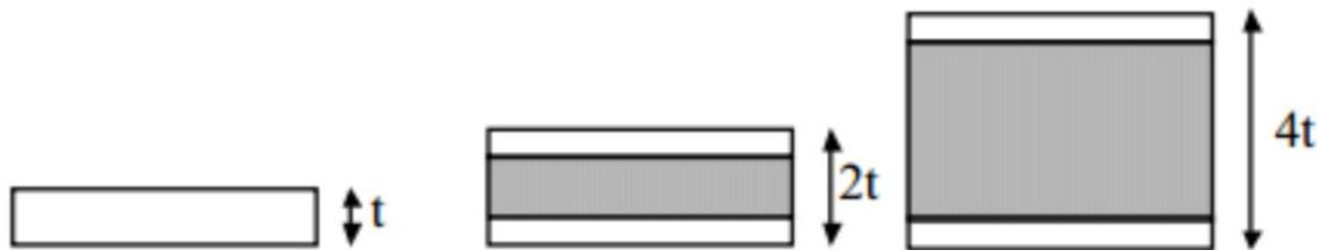
Fig 2. Estructura tipo sándwich.
