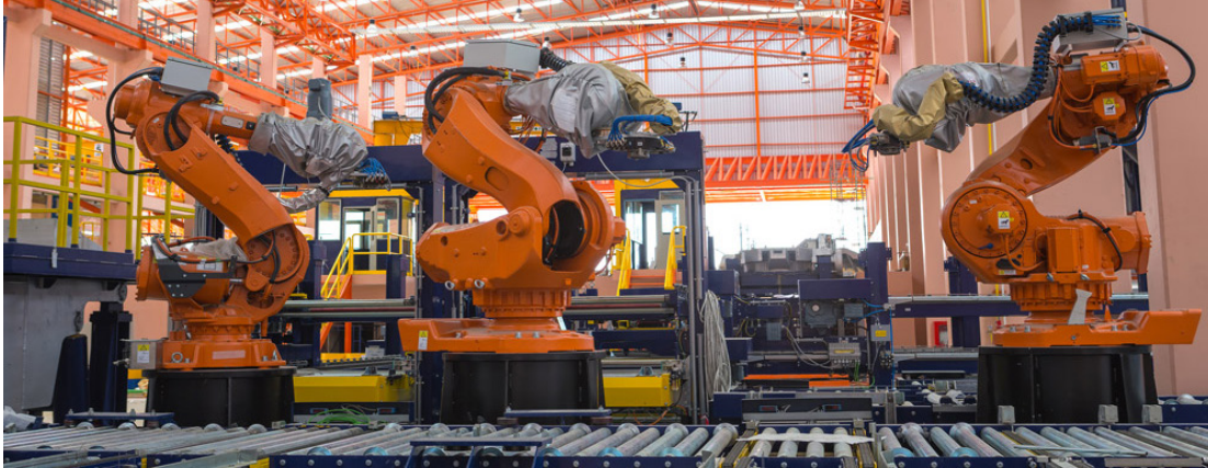
Fig.83 Robot usado para las uniones mango y recipiente. Recuperado de https://tinyurl.com/y4dygrhq
