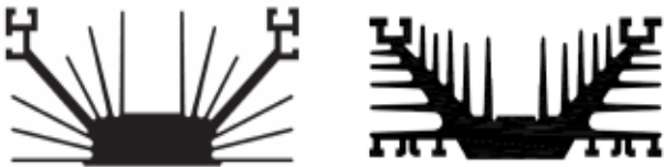
Fig. 33 Disipadores extruidos complejos. Recuperado de https://tinyurl.com/y3j76gto
