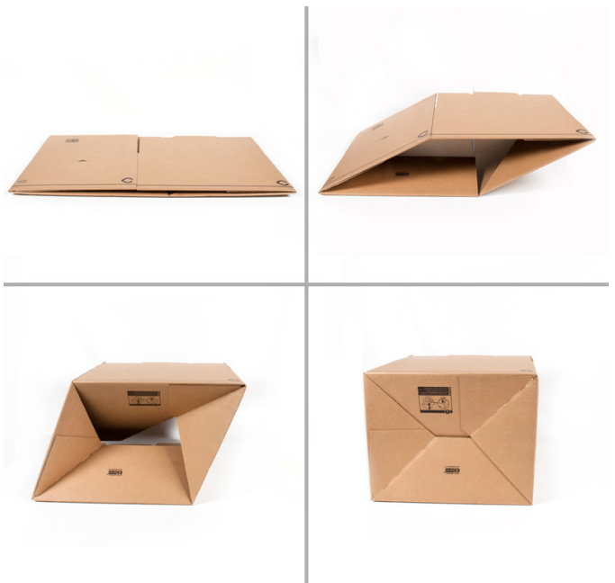
Fig.104 Ejemplo montaje caja de fondo automático. Recuperado de https://tinyurl.com/y2rrvtso
