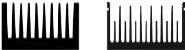
Fig. 34 Disipadores extruidos simples. Recuperado de https://tinyurl.com/y3j76gto
