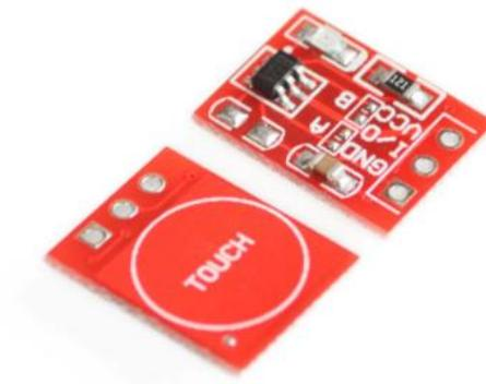
Fig. 3.14 – Sensor capacitivo
