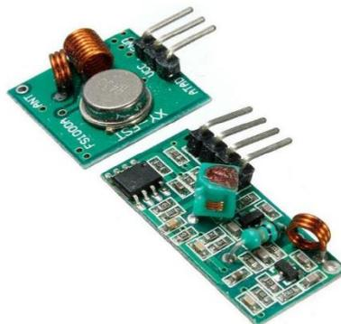
Fig. 3.5 – Trasmisor y Receptor
