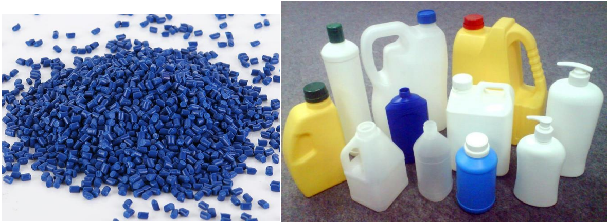
Fig. 7.2_4 – Granza (izquierda) y piezas de polietileno de alta densidad.
