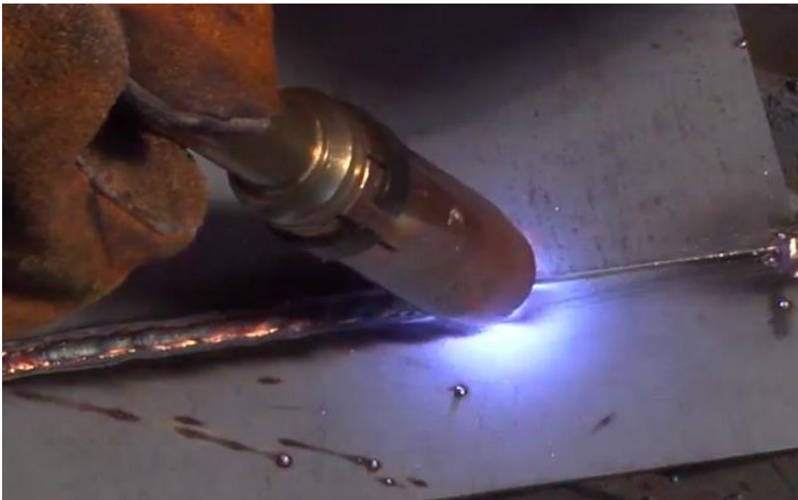
Fig.3_1_PC - Soldadura MIG
