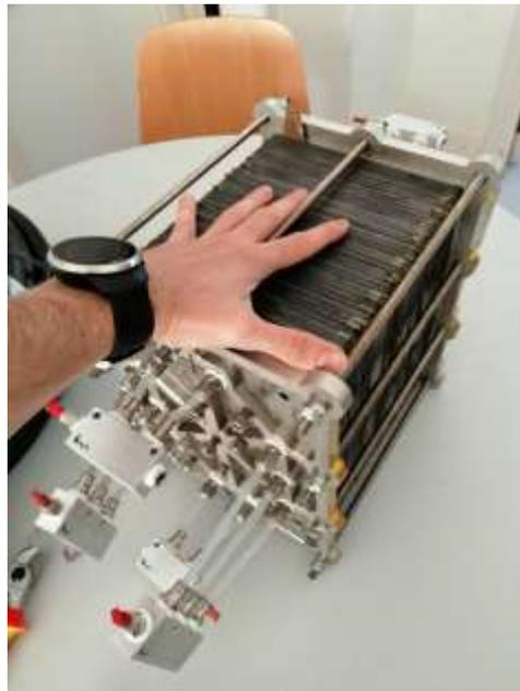
Ilustración 2: Pila de combustible de alta temperatura utilizada en el prototipo del CEU-UCH
