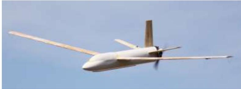
Ilustración 3: Ápeiron, el avión no tripulado alimentado por hidrógeno.
