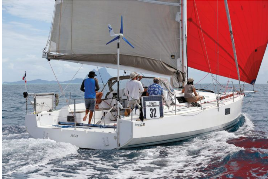
Ilustración 24. Aerogenerador instalado en la popa de un velero
