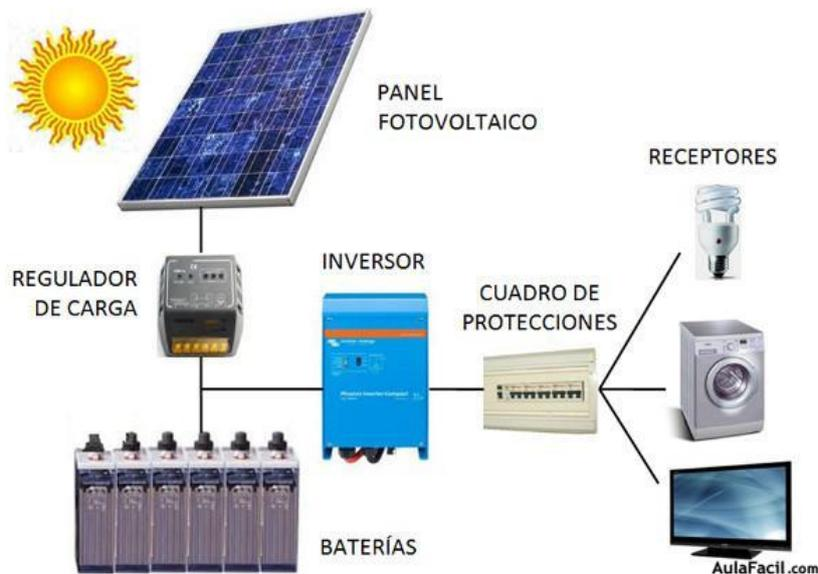
Figura 15: Esquema de una instalación FV aislada típica. (GlobalElectricity)
