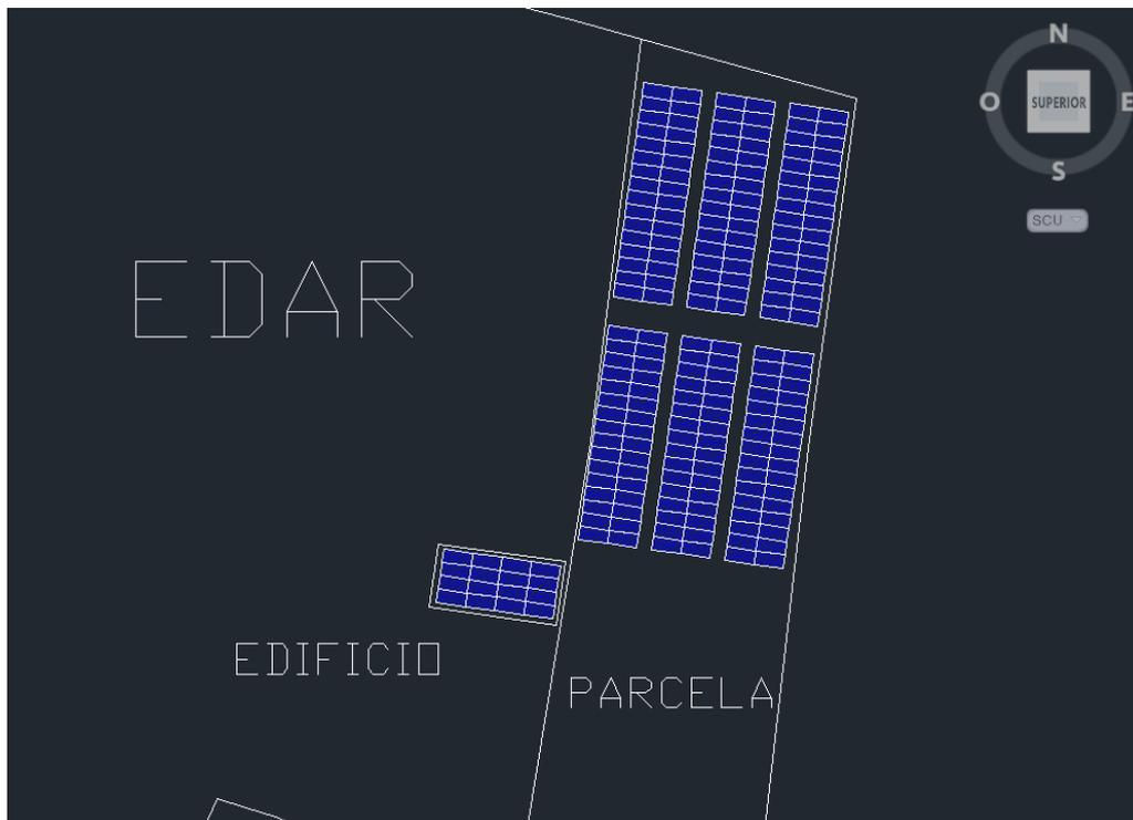
Figura 41: Distribución de paneles para la configuración 1. (Creación propia con Autocad)
