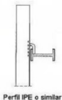
Imagen 18: Sujeción del panel a las correas.
