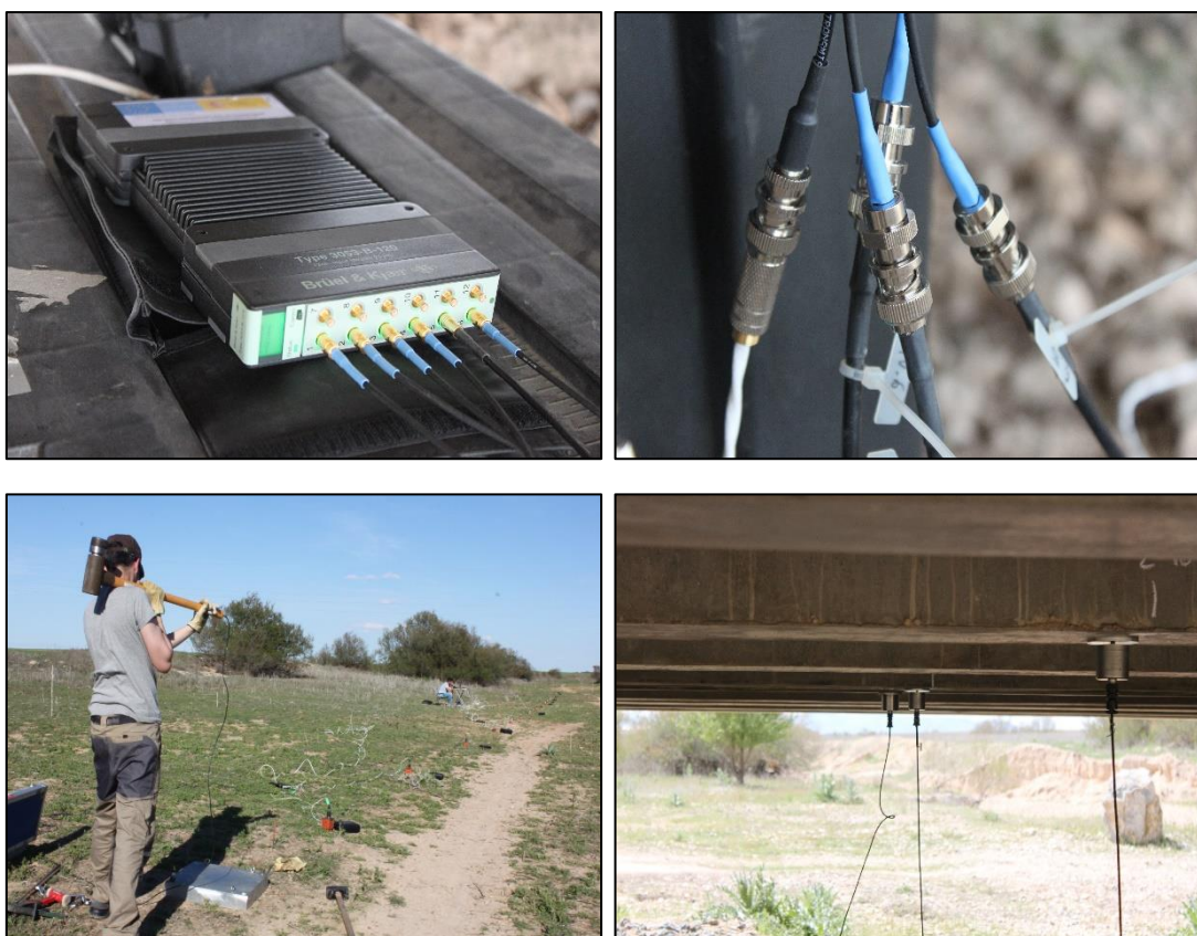
Figura 45: D'esquerra a dreta i de dalt a baix: Sistema d'adquisició de dades LAN-XI de Brüel & Kjaer; connexió entre els sensors i el sistema d'adquisició; muntatge per a la prova de sòl i sensors col·locats al pont per a obtenció de la resposta dinàmica (15).
