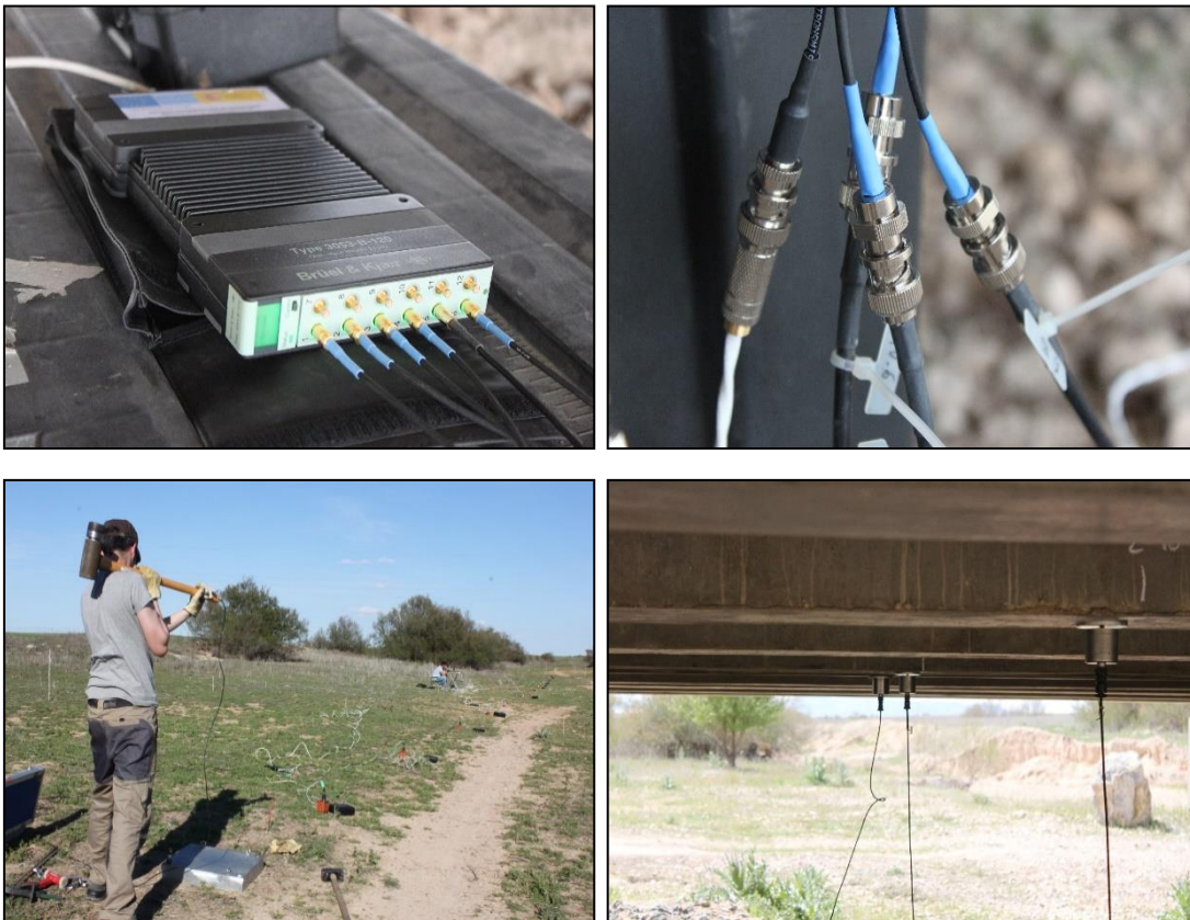
Fig. 45: De izquierda a derecha y de arriba abajo: Sistema de adquisición de datos LAN-XI de Brüel & Kjaer; conexión entre los sensores y el sistema de adquisición; montaje para ala prueba de suelo y sensores colocados en el puente para obtención de la respuesta dinámica.
