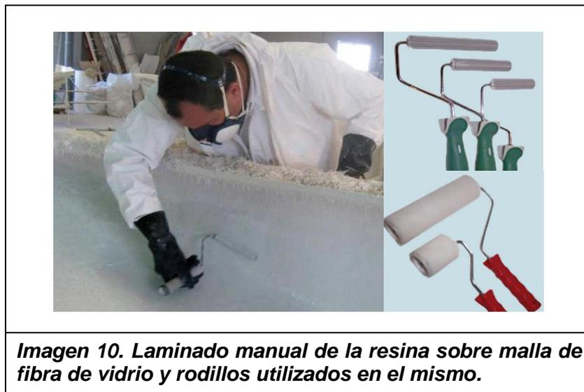
**Imagen 10. Laminado manual de la resina sobre malla de fibra de vidrio y rodillos utilizados en el mismo.**
