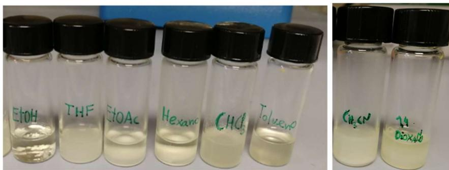
**Figura 14.** Ensayos de gelificación en disolventes orgánicos.
