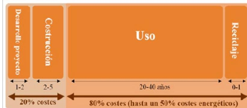
Figura 8. Estructura de costes de un edificio durante su ciclo de vida. Fuente: German Energy Agency
