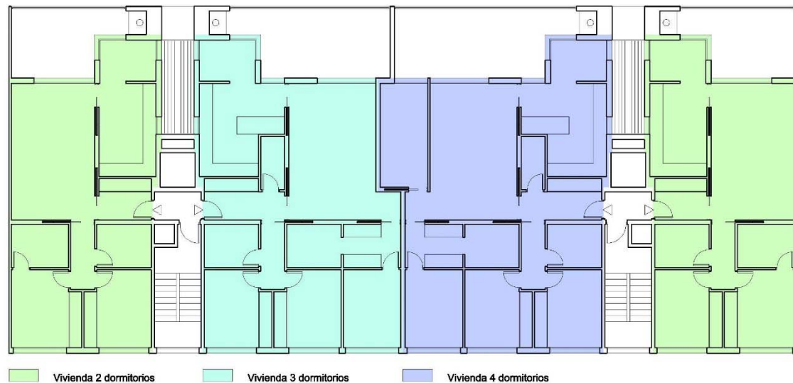
Figura 59. Planta del edificio. Tipologías de vivienda
