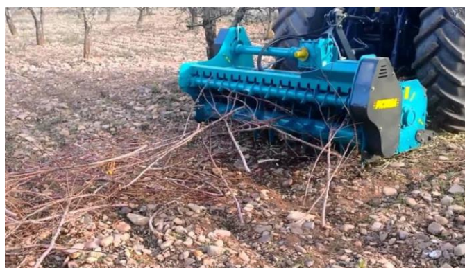
Figura 79. Triturado de restos con tractor. Fuente: elaboración propia.
