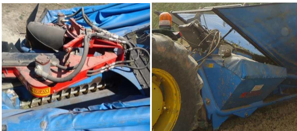
Figura 120 - 121. Tornillo sin fin y tolva de recepción. Fuente: elaboración propia.
