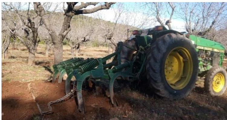
Figura 66. Tractor con cultivador y tabla realizando laboreo. Fuente: Elaboración propia.
