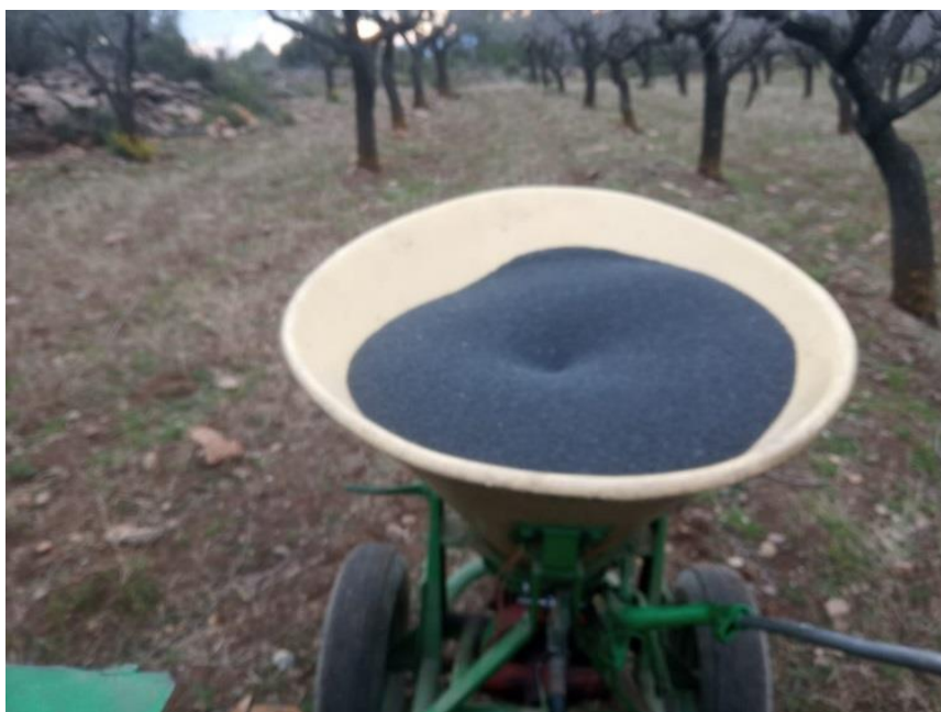
Figura 65: Abonadora centrífuga. Fuente: elaboración propia.
