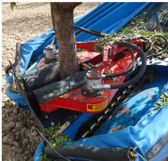
Figura 119. Pinza abrazando al tronco para vibrarlo. Fuente: elaboración propia.
