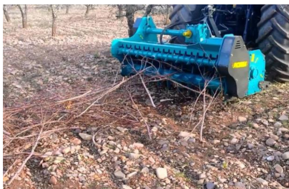
Figura 60. Trituración de restos con tractor y trituradora de martillos. Fuente: elaboración propia.
