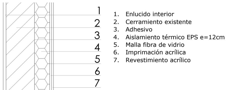
Figura 19. Detalle cerramiento existente + SATE Fuente: Elaboración propia.
