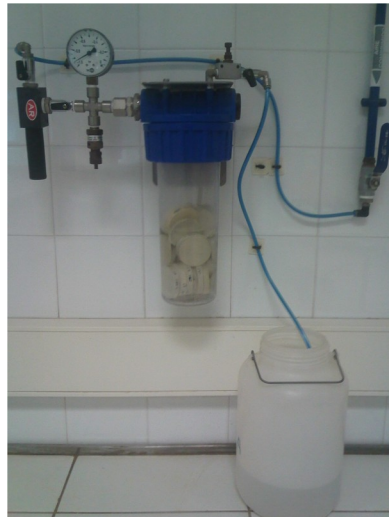
Figura 5. Cámara de vacío para la determinación de absorción de agua
