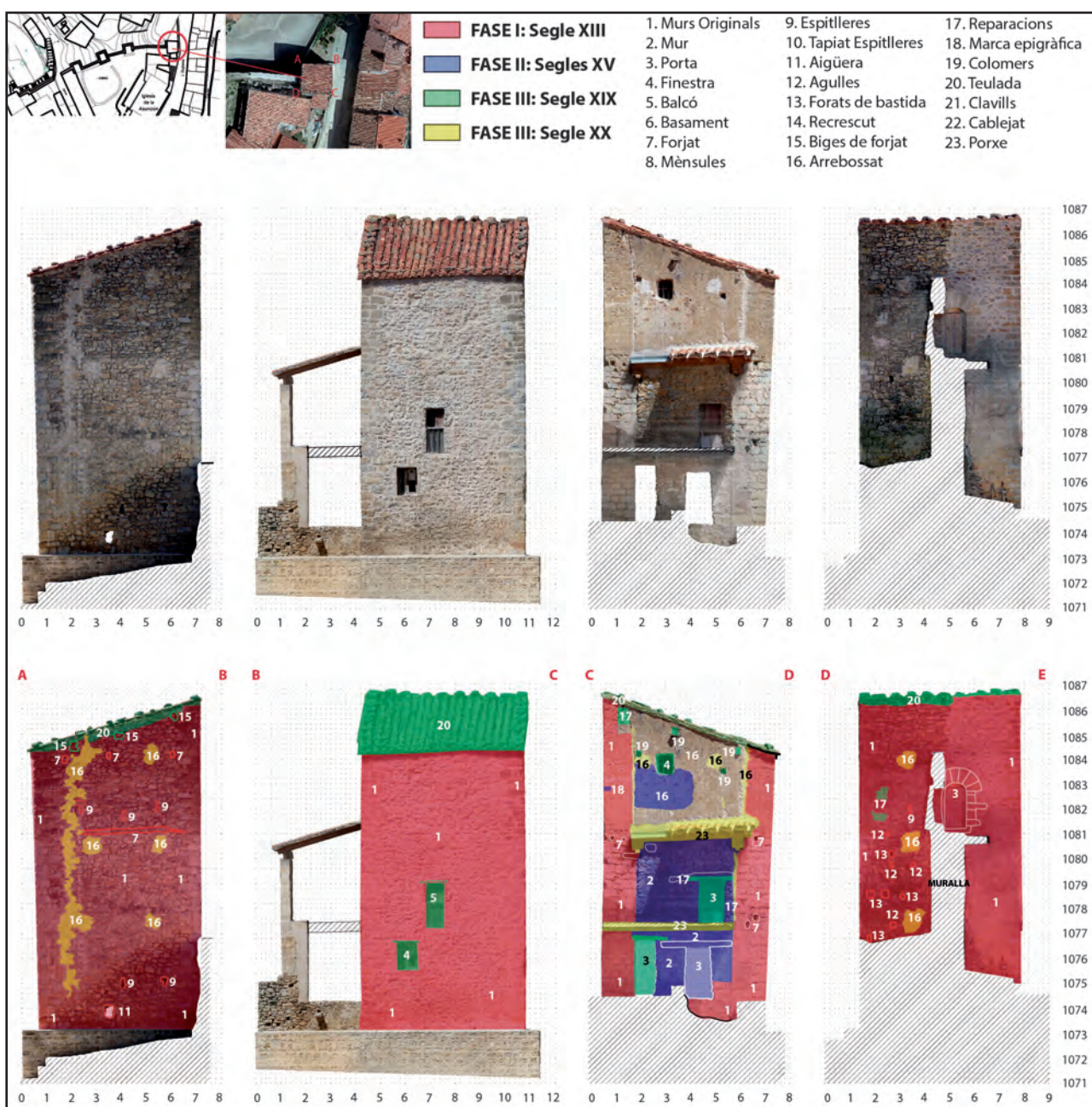
Figura 5. Fotogrametria dels alçats externs de la bestorre 6 amb descripció dels elements arquitectònics més importants i de les fases constructives.
