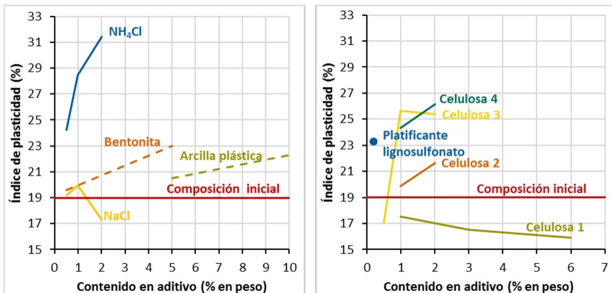
**Figura 2.** Efecto del contenido en aditivo sobre el índice de plasticidad.
