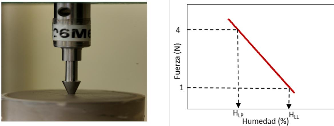
**Figura 1.** Punzón para la medida del índice de plasticidad mediante el método de indentación (izquierda). Gráfico para el cálculo de los límites de Atterberg (escala logarítmica) (derecha).
