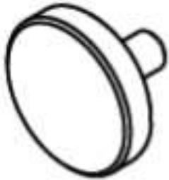
En el diseño encontraremos tres tornillos de este estilo; todos con una misma función: mantener la posición escogida en el momento mediante un apriete manual.
