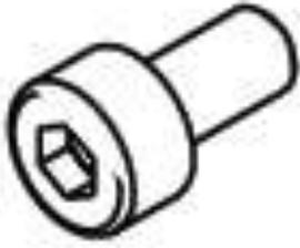
En el diseño encontraremos cuatro tornillos de este estilo. Todos con la función de mantener la posición escogida en el momento sin necesidad de un apriete manual.
