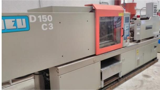
*Figura 213 – Inyectora del mercado de segunda mano Sandretto DEU D150 C3*
