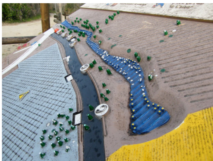
Figura 4: Plano táctil realizado con resinas con cargas de color y polvo de mármol situado en un contexto cerca del mar, apreciándose la degradación y suciedad acumulada.
