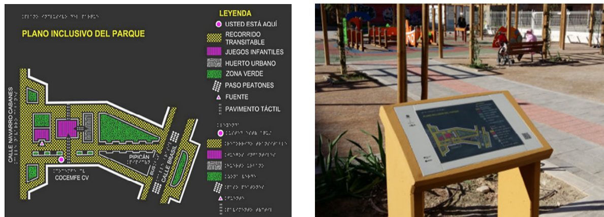
Figura 2. Primera implementación del producto Kersings instalada en un parque, mostrando el plano desarrollado y su montaje sobre una peana de hormigón armado (Gual et al., 2018).
