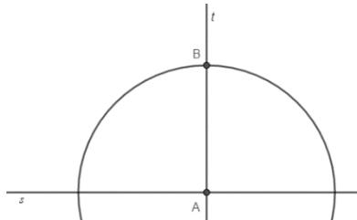
Con centro en B y una abertura de 1,8 dm dibujamos un arco de circunferencia que corte la recta  $s$  a ambos lados de la recta  $t$ , puntos que llamaremos «C» y «D». El segmento CB y el segmento DB representan los lados de la escalera y la longitud del segmento CD sería la distancia que separa los pies de la misma. Luego podremos medirlo con una regla, y deshaciendo la escala sabremos la medida real, por lo tanto, el problema es resoluble.
