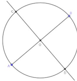
Para dibujar la otra diagonal del cuadrado, como  $70,71 \text{ mm} : 2 = 35,35 \text{ mm}$ , con el compás y una apertura de 35,35 mm, aproximadamente, con centro en el punto O, trazamos una circunferencia que cortará la mediatriz en los puntos «C» y «D». Ya tenemos la otra diagonal, CD.
