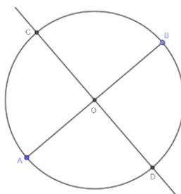
Para dibujar la otra diagonal del cuadrado, como  $70,71 \text{ mm} : 2 = 35,35 \text{ mm}$ , con el compás y una abertura de 35,35 mm, aproximadamente, con centro en el punto O, trazamos una circunferencia, que cortará la mediatriz en los puntos «C» y «D». Ya tenemos la otra diagonal, CD.
