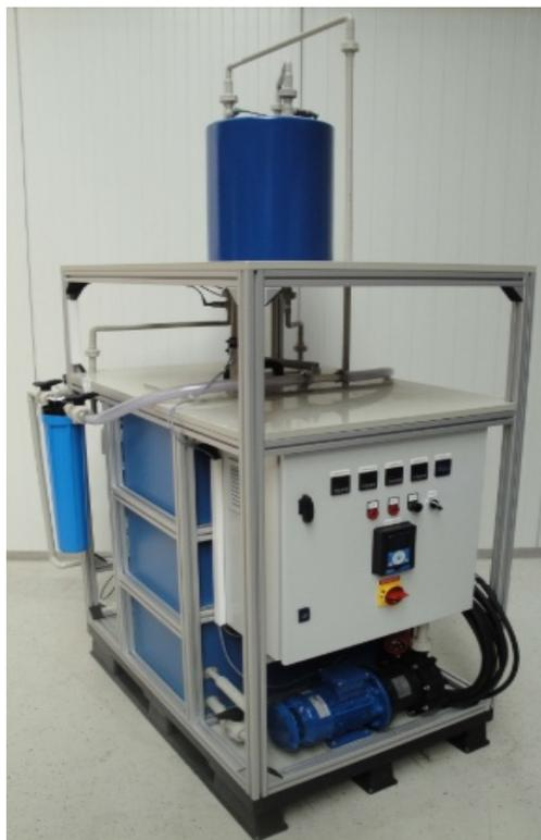
**Figura M7.7.** Planta de laboratorio de destilación por membranas [12].
