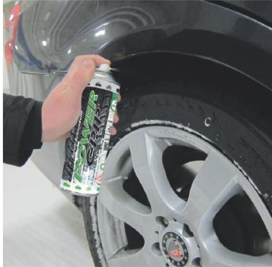
Imagen 1.6 Aplicación del aerosol antideslizante
