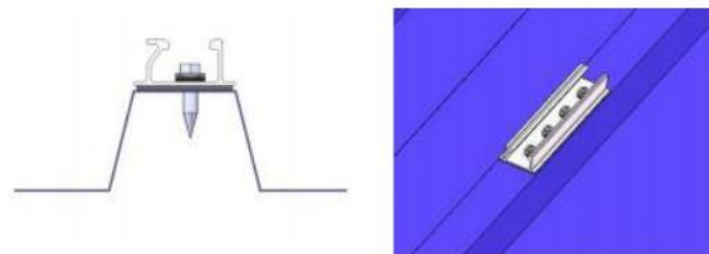
Figura 89: Muestra de la sujeción mediante trapezoidal atornillado a pletina sobre greca. Fuente: Portal Solar.
