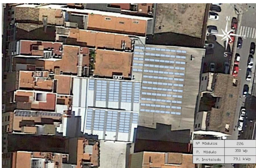
Figura 67: Propuesta B, todos los módulos con orientación sur. Además, módulos en el agua norte con estructura para rectificarlos hacia orientación sur también. Fuente: Creación Propia.
