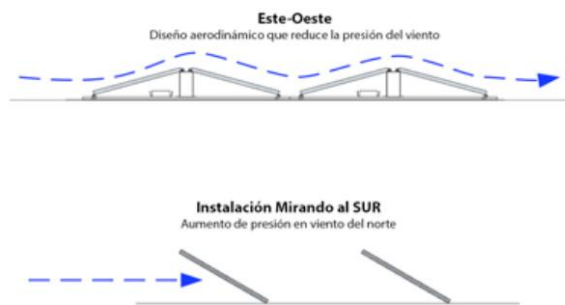
Figura 77: Efecto del viento en configuración este-oeste vs hacia sur con estructura. Fuente: MonSolar.
