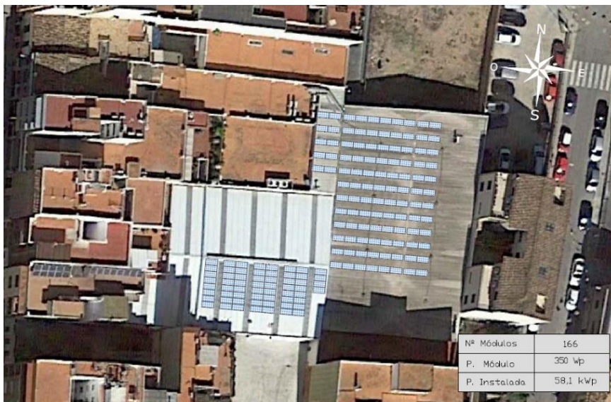
Figura 66: Propuesta A, todos los módulos con orientación sur. Fuente: Creación Propia.
