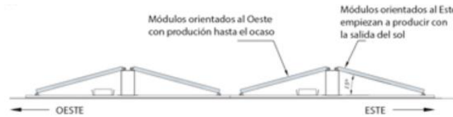
Figura 76: Configuración Este-Oeste. Fuente: MonSolar.
