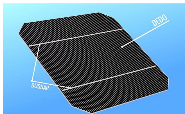
Figura 8: Célula FV de 2BB, donde se ven los dedos y ambas barras colectoras o bus bars. Fuente: Learn Engineering.
