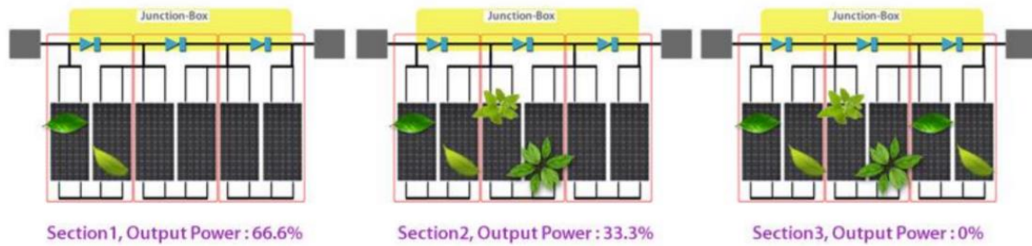
Figura 28: Esquema del funcionamiento de los diodos de bypass. Fuente: EE1028 - Instalaciones de EERR - UJI.
