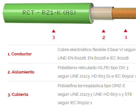
Figura 108: Cable unipolar RZ1-K (AS) 0,6/1kV para la parte de alterna. Fuente: Cables RCT.
