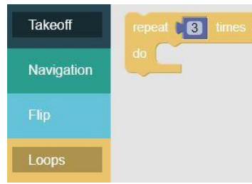
Figura 5.2.10. Menú Loops. La instrucción repeat nos permite repetir una o varias instrucciones un número de veces determinado.
