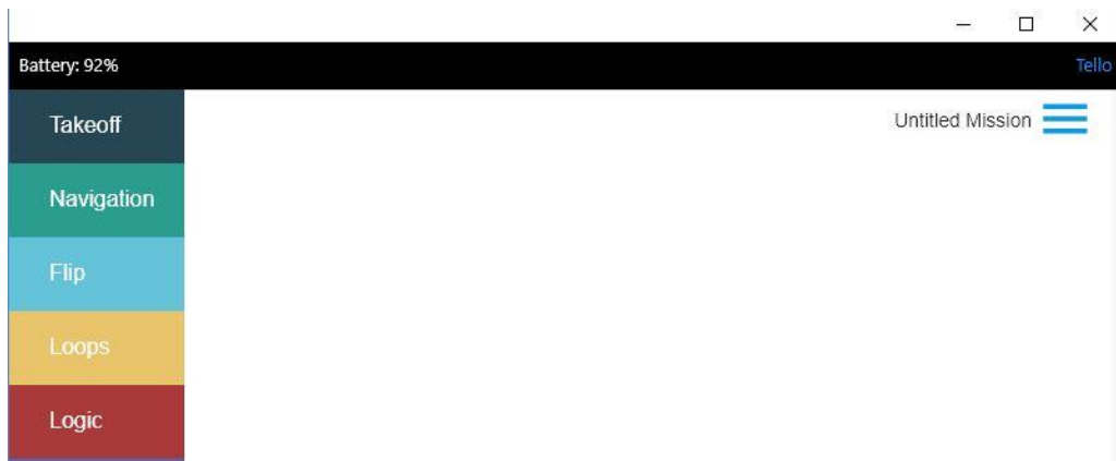
Figura 5.2.7. La palabra Tello en la esquina superior derecha y el porcentaje de la carga de la batería en la esquina superior izquierda, nos indica que estamos conectados con el dron Tello.
