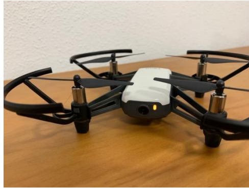
Figura 5.1.5. El led rojo parpadeando, nos indica que Tello esta encendido.
