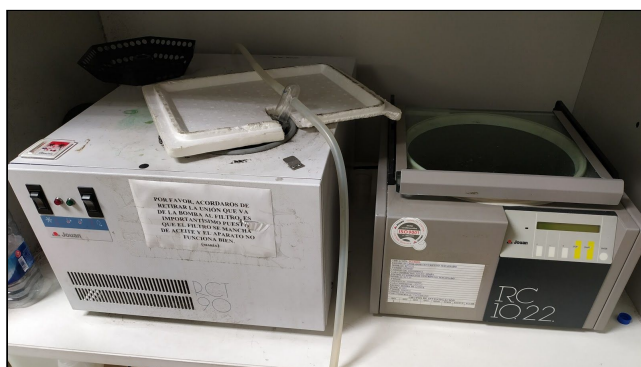
Figura 6: Evaporador centrifugo teflonado Modelo: RC10.22 Casa comercial: JOVAN-IZASA
