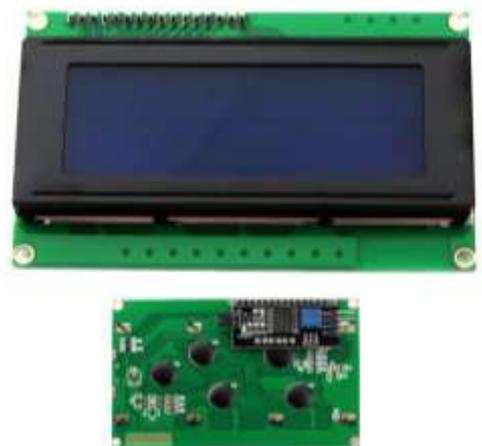
Ilustración 10: pantalla LCD de 20x4 píxeles con módulo I2C
