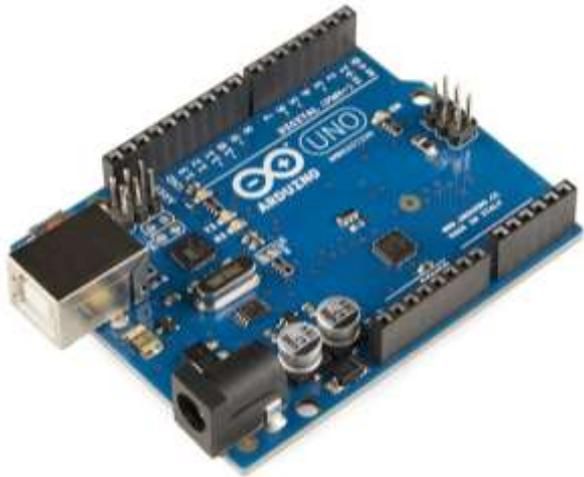
Ilustración 7: Imagen de placa Arduino UNO.
