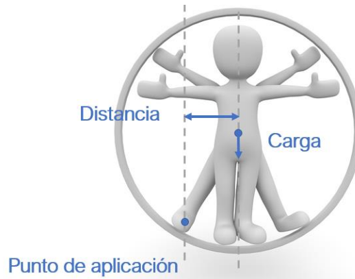
Figura 57 Modelización del momento aplicado
