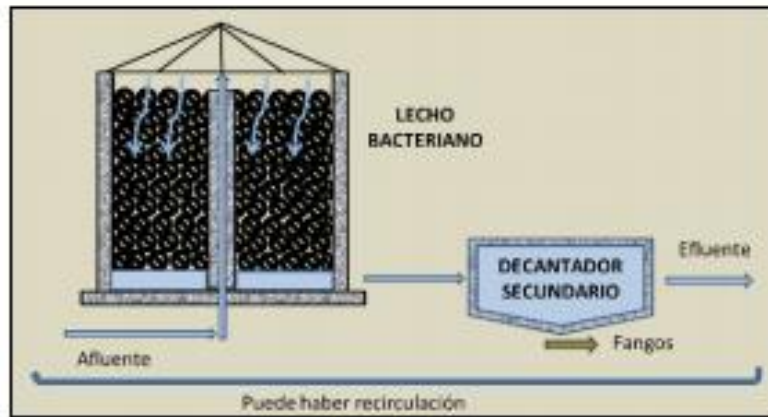
Figura. M. 8. Esquema de un lecho bacteriano.
