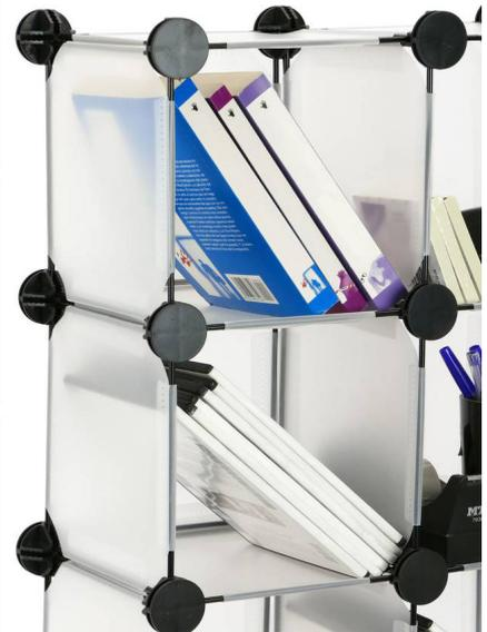
La simpleza de las uniones y la facilidad de montaje y desmontaje de este producto es un claro ejemplo de modularidad. Con dos simples módulos diferentes puedes crear una estantería del tamaño que se necesite o se desee. La fabricación de este producto también es de lo más sencilla, con una simple pieza inyectada, una barilla de metal y láminas de plástico ya se puede realizar el producto al completo.
