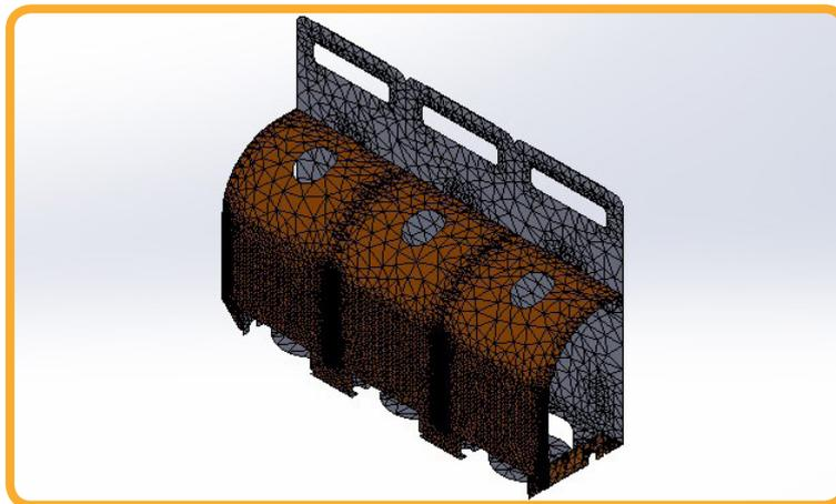
*Fig 114: Mallado módulo de 3*
