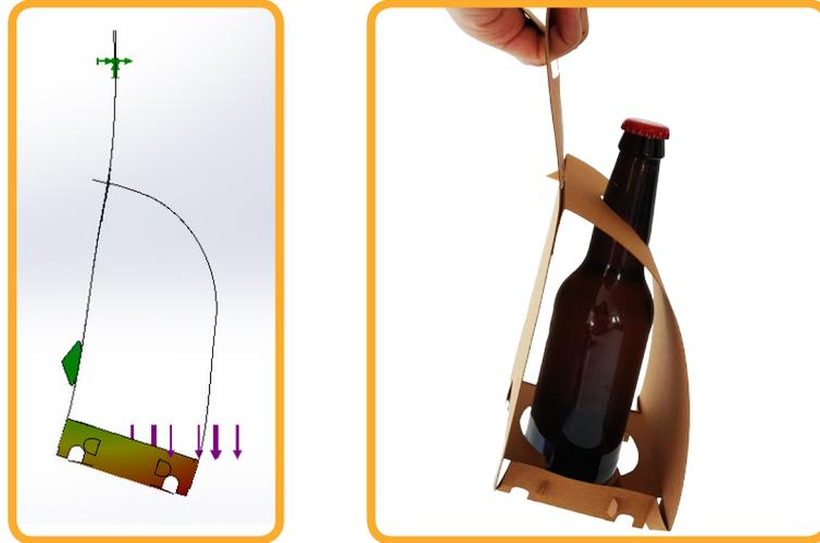
*Fig 112: Comparativa simulación (izquierda) y prototipo físico (derecha)
