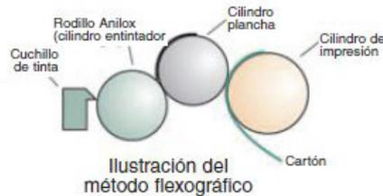
*Fig 97: Impresión flexográfica*
