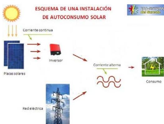
Fig. 1.11: Esquema de una instalación conectada a red
