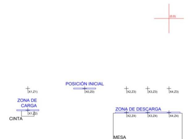
Figura 47. Célula de clasificación (vista lateral)
