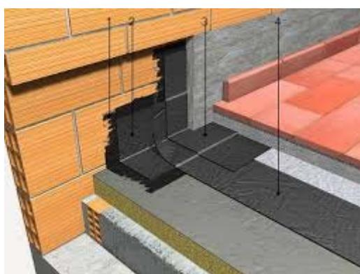
Figura 13. Cubierta plana transitable con aislamiento (Fuente: [www.carm.generadordeprecios.info](http://www.carm.generadordeprecios.info))
