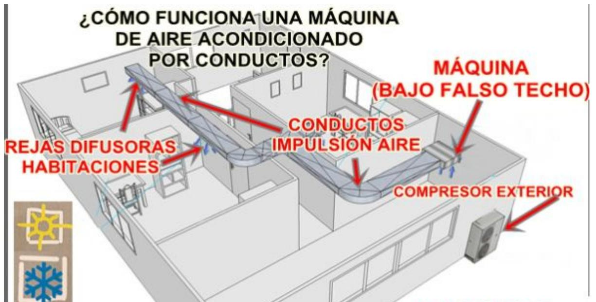
Figura 18. Aire acondicionado por conductos (Fuente: [www.instalacionescollado.com](http://www.instalacionescollado.com))
