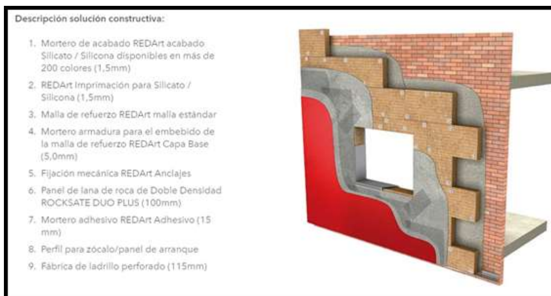
(Figura 23: Sistema SATE tipo REDArt; Fuente: www.rockwool.es )
