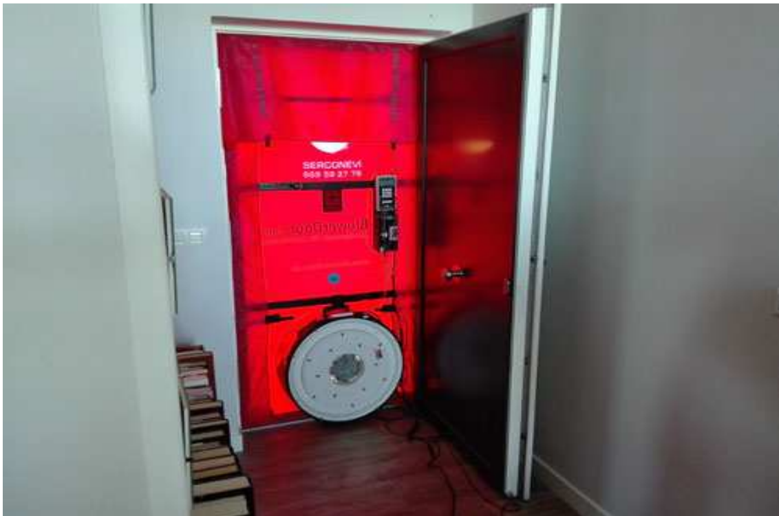
Figura 94: Ensayo de Blowerdoor. Fuente: https://www.google.es/search
