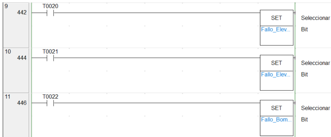
Figura 1.9. Programa Cuadro General Pera: Activación marca fallo contactor
