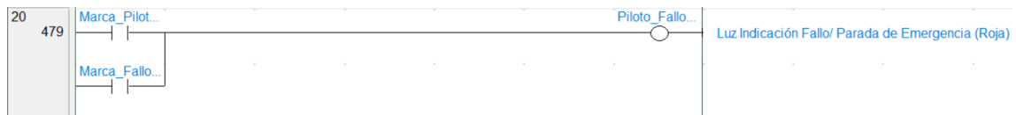
Figura 1.12. Programa Cuadro General Pera: Activación señalización luminosa de fallo
