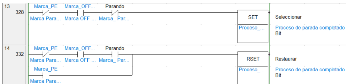
Figura 1.23. Programa Cuadro General Pera: Activación/desactivación marca proceso parada completado
