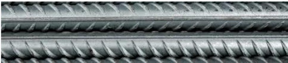
*Fig.10 Muestra de varilla de acero corrugado.*
