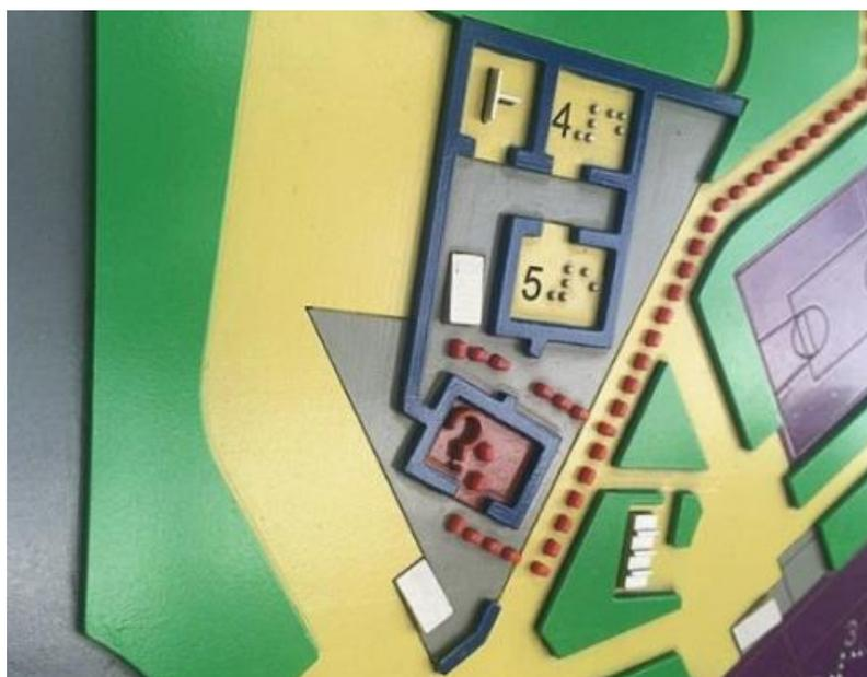
*Fig.2 Mapa táctil de un parque de Hong Kong realizado mediante recorte de láminas de plástico.*
