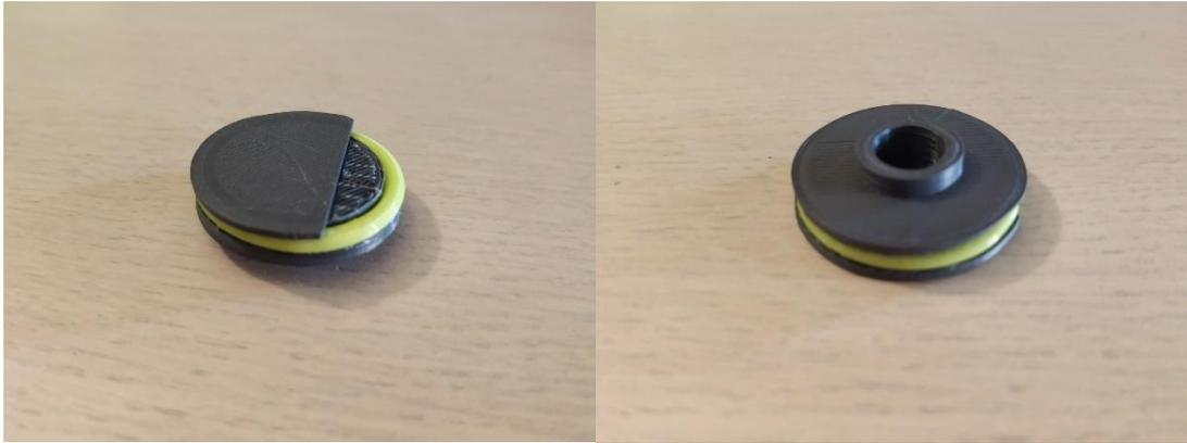
**IMAGEN 113.** PROTOTIPO DEL ÉMBOLO DE LA VARILLA Y LA JUNTA TÓRICA GRANDE<sup>4</sup>
