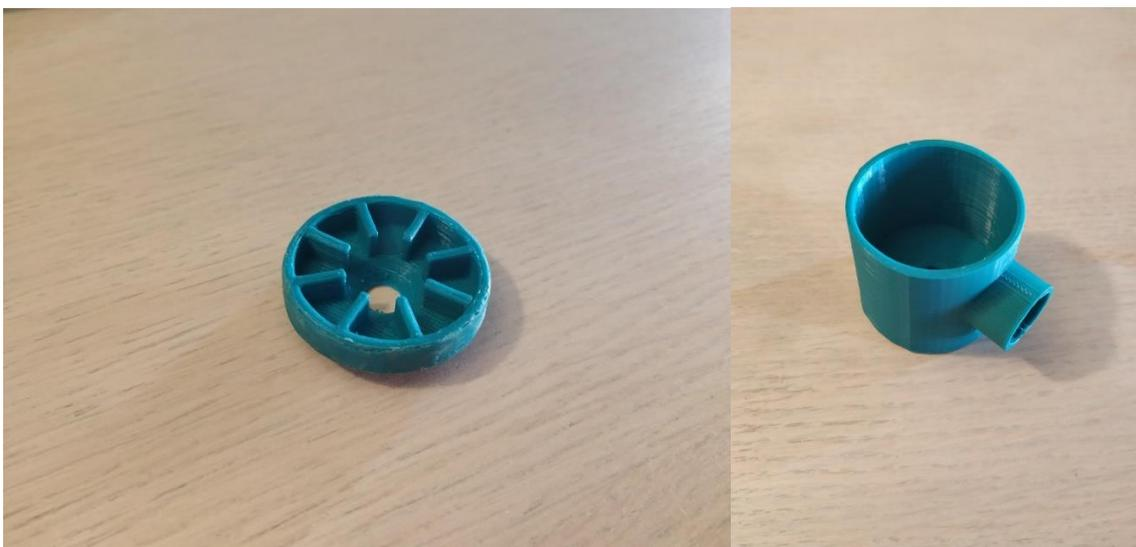
**IMAGEN 116.** PROTOTIPOS DEL SOPORTE DE LA VÁLVULA Y LA CÁMARA DE DESCOMPRESIÓN
