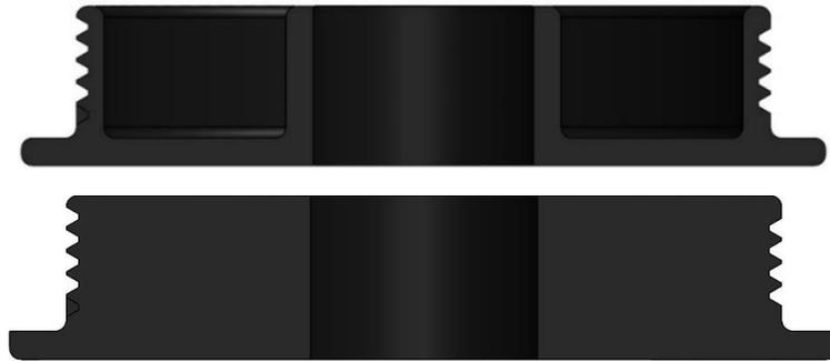
IMAGEN 138. SECCIÓN DE LA TAPA DE LA CÁMARA PEQUEÑA
