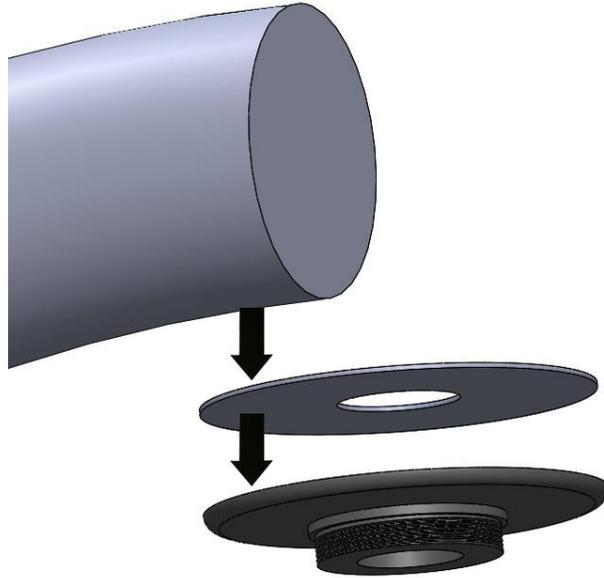
IMAGEN 131. UNIÓN COSTILLA-SOPORTE DE LA CUBIERTA
