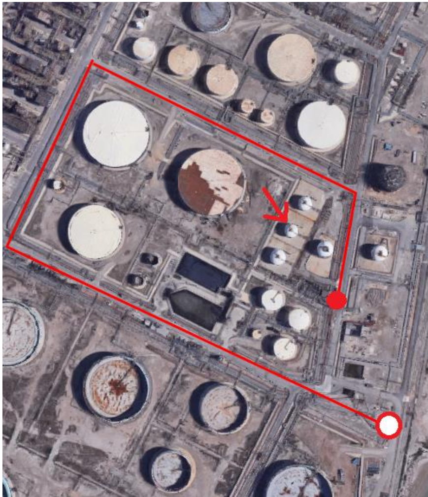
Ilustración 60: Trazado más largo del escenario de incendio de la esfera 705.
