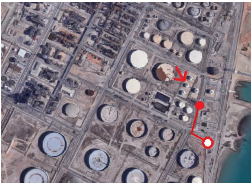
Ilustración 57: Recorrido de bombeo en incendio de la esfera 705.
