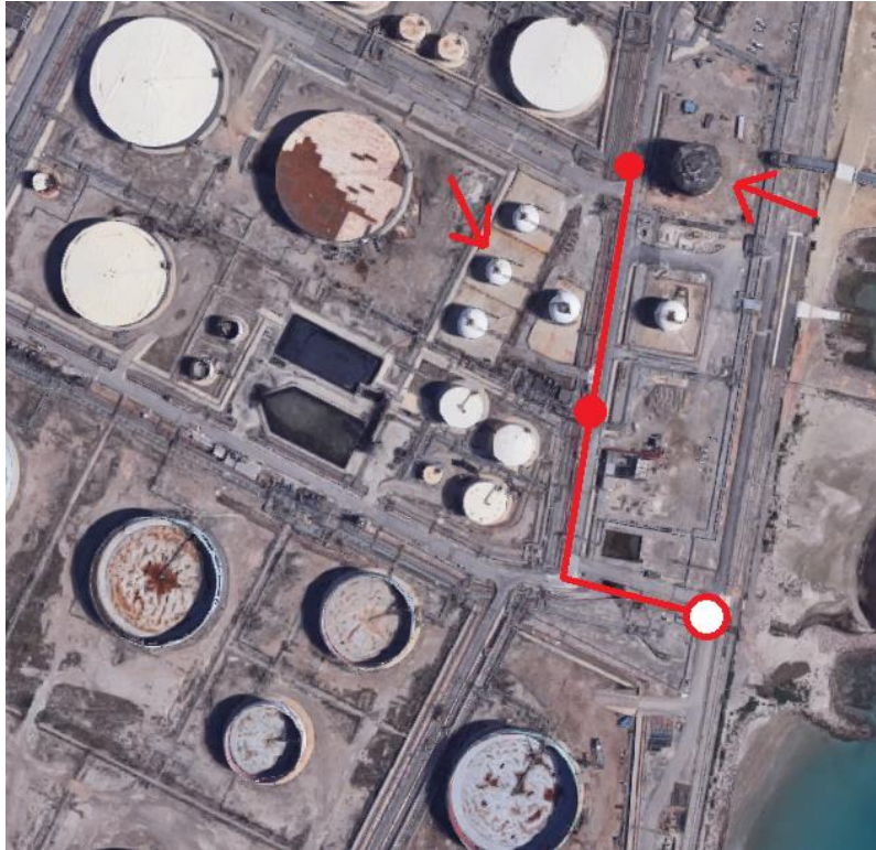
Ilustración 67: Recorrido de bombeo del escenario conjunto.
