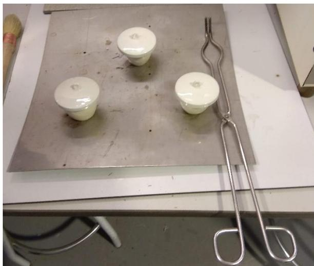
**Ilustración 84:** Crisoles enfriándose con la tapa puesta para evitar que cojan humedad
