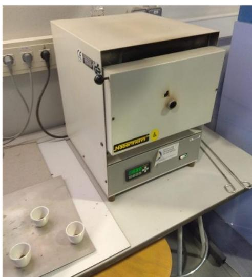
Ilustración 81: Horno mufla “NABERTHERM”
