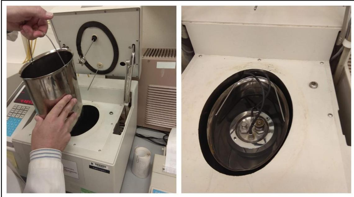
**Ilustración 90:** Colocación de la lechera en el calorímetro
