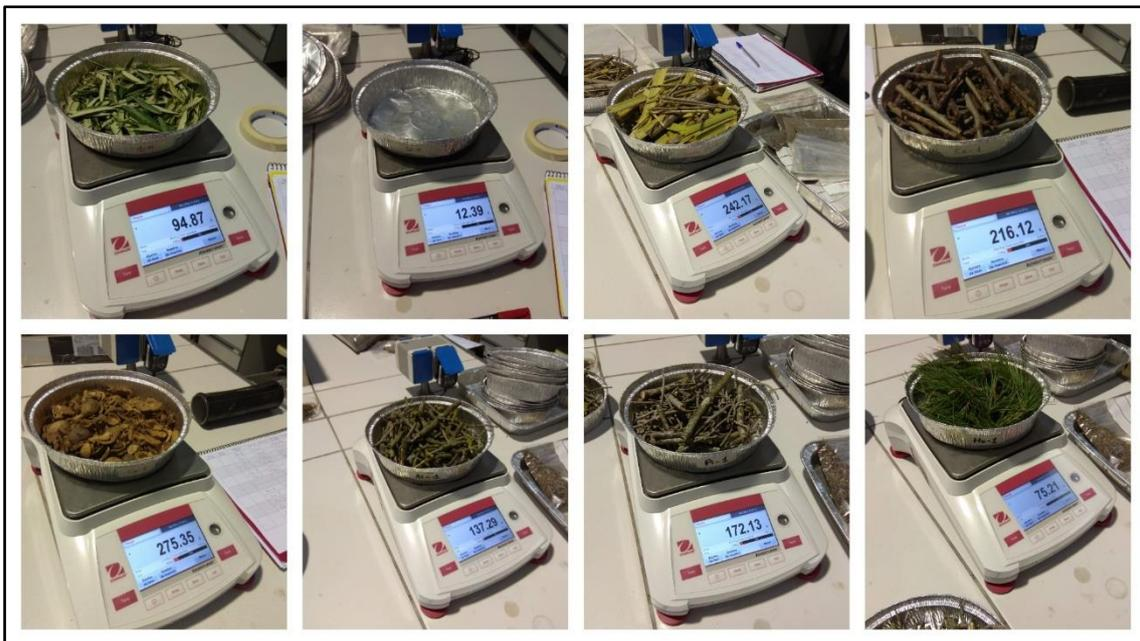
**Ilustración 75:** Pesado de los crisoles llenos
