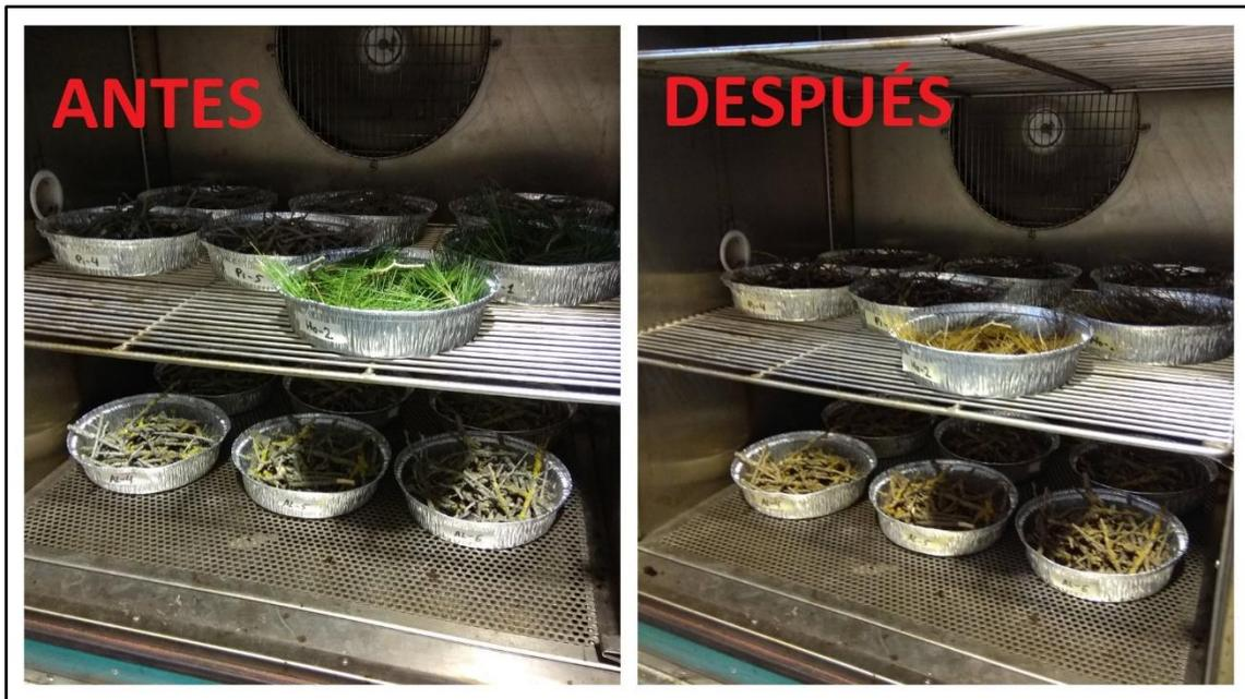
**Ilustración 76:** Antes y después del paso de los crisoles por la estufa
