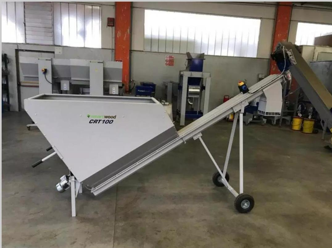
**Ilustración 17:** Cargador / dispensador de materias primas - CRT-100
