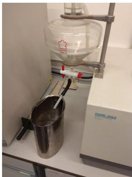
**Ilustración 89:** Llenado de la lechera con el aforo del sistema de manejo de agua PARR 1563
