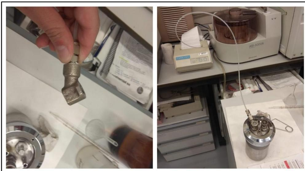
**Ilustración 88:** Llenado de la bomba con  $O_2$
