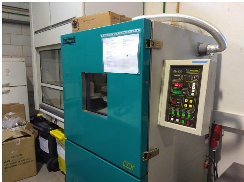
Ilustración 72: “CÁMARA DE ENSAYOS CLIMÁTICOS DICOMETAL, SERIE CCK”
