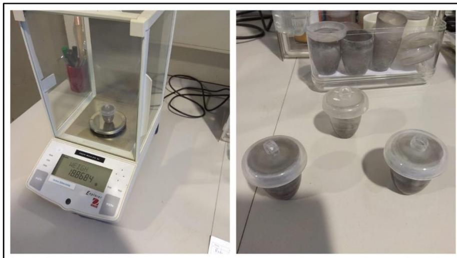
**Ilustración 93:** Pesado de crisoles
