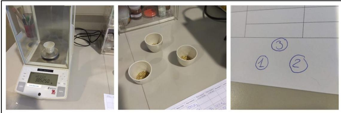
**Ilustración 82:** Proceso de pesado de crisoles
