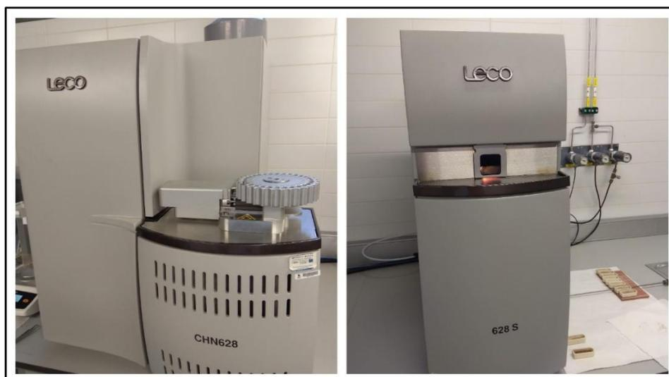
Ilustración 96: Instrumento de análisis LECO CHN628 (derecha) y Instrumento de análisis LECO 628 S (izquierda)
