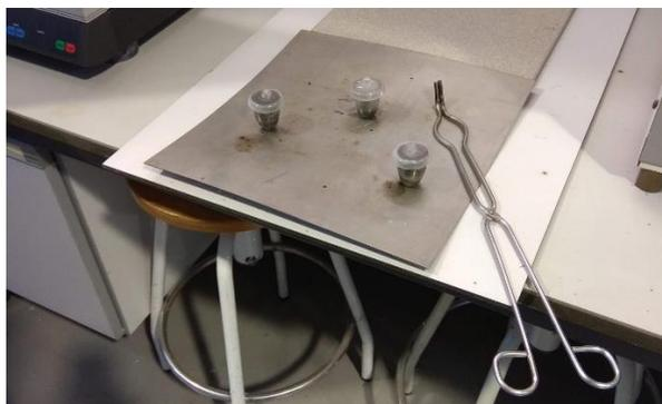
**Ilustración 95:** Enfriado de los crisoles
