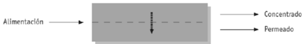
Figura M.13. Esquema de filtración tangencial.
