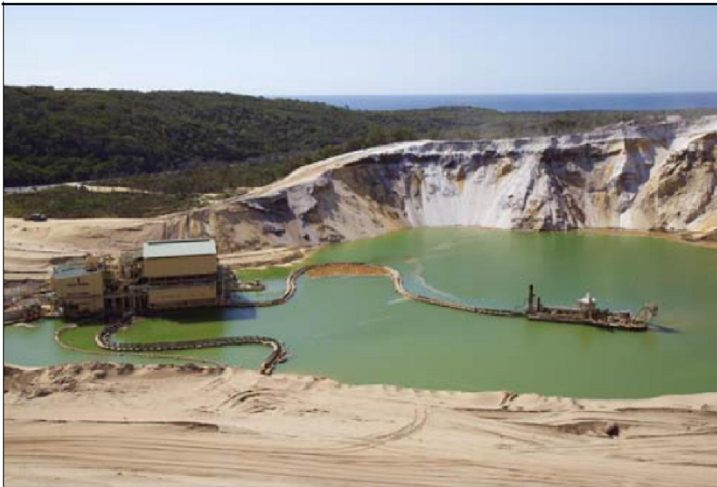
Figura M.4.9. Minería en húmedo. Recuperado de "ZIA. Technical handbook on zirconium and zirconium compounds. Second edition, August 2015".
