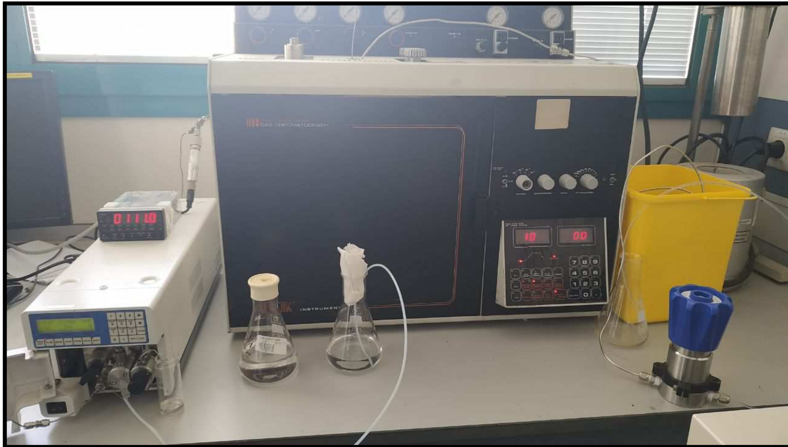
Esquema 20: Fotografía del sistema de flujo continuo representado en los Esquema 12 y Esquema 14.
