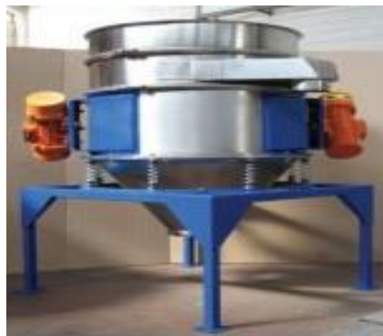
Figura 7.19. Tamizadora del tiesto cerámico.
