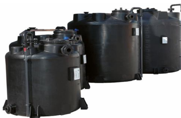
Figura 7.8. Tanque para el hidróxido sódico.
