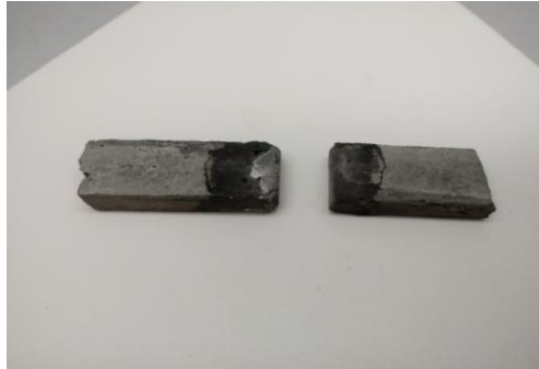
Figura 1.1. Eflorescencias formadas en las piezas.
