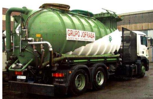
Figura 7.6. Camión cisterna utilizado para transportar las cenizas.
