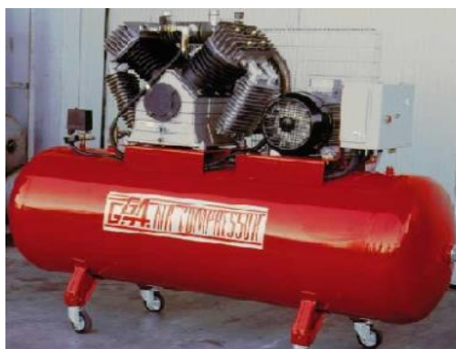
Figura 7.7. Compresor industrial de aire.
