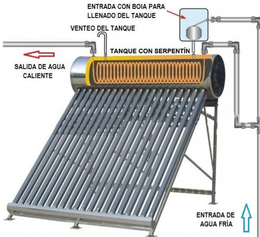
La instalación se ejecuta en tubería de cobre estirado sin soldadura, desoxidado con fósforo, estancas a una presión mínima de 10 atmósferas. La sección será circular y espesor uniforme, las superficies exteriores e interiores serán lisas y estarán exentas de rayas, manchas, sopladuras, escorias, picaduras o pliegues. Las uniones y las piezas especiales irán soldadas con estaño-plata y con accesorios mixtos soldados-roscados para las tomas finales de aparatos.
